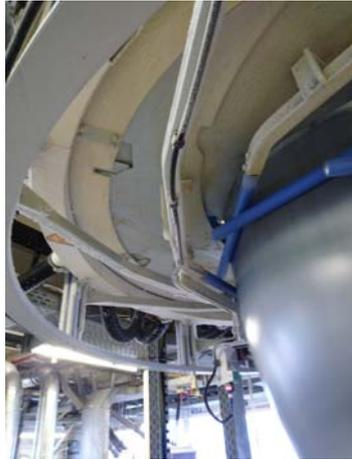
Bild 3 Schwenkarmkalibrierung CENTRO-E mit integrierter Monomerabsaugung "ES"
