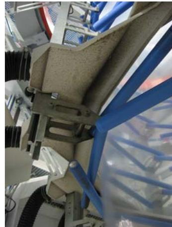
Bild 2 Absaugelemente an der Folienblase
